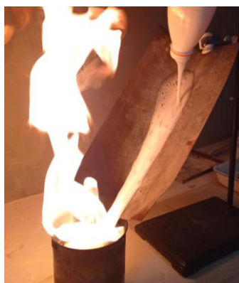
Рис. 3. Подавання ШТП на поверхню метанолу в лабораторному модельному вогнищі
