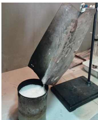
Рис. 4. Припинення горіння метанолу після подавання ШТП
