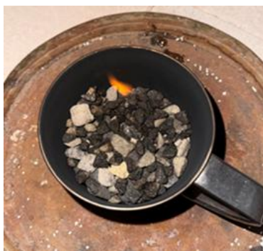
Рис. 2. Етапи гасіння метанолу системою ППС + перліт (горіння після нанесення шару ППС 3,5 см)
