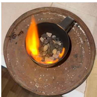
Рис. 1. Етапи гасіння метанолу системою ППС + перліт (горіння після засипки шару ППС висотою 4 см)
