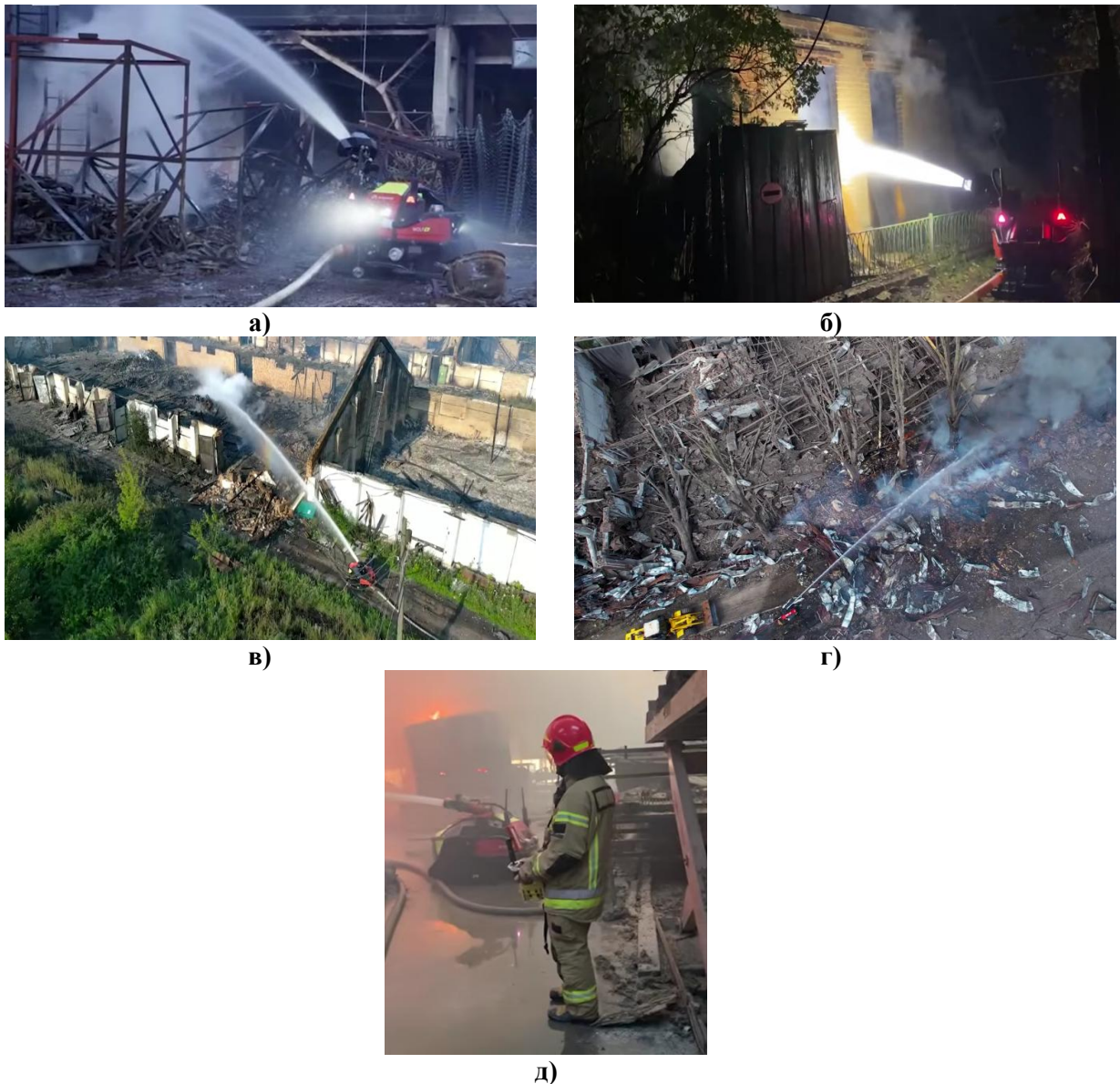
Рис. 1. Гасіння пожеж із застосуванням роботизованих комплексів, зокрема платформи Magirus Wolf R1: а – промзона; б – приватний будинок; в – склад; г – в зоні бойових дій; д – робоче місце оператора
