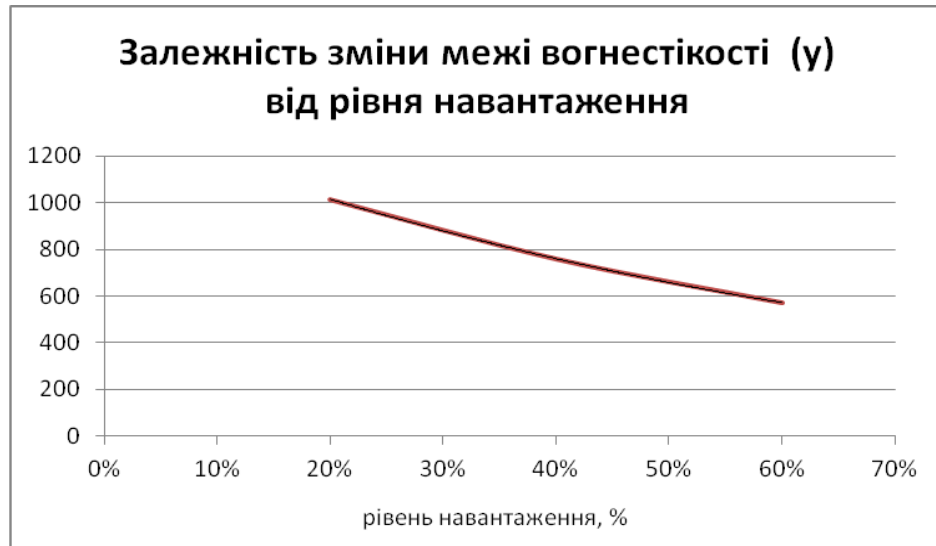
Рис. 10. Графік залежності зміни межі вогнестійкості досліджуваної сталеві колони від рівня прикладеного механічного навантаження.
