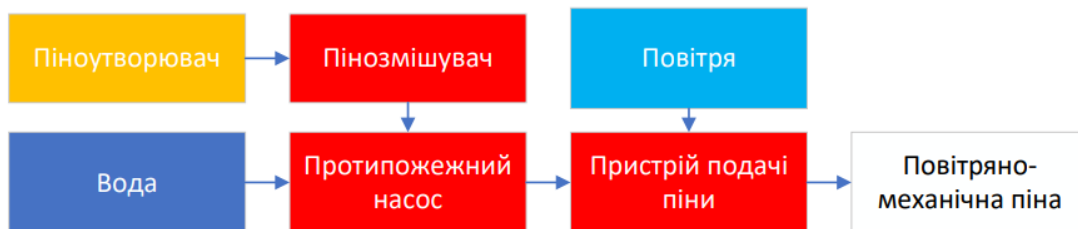
Рис. 1. Процес отримання повітряно-механічної піни
