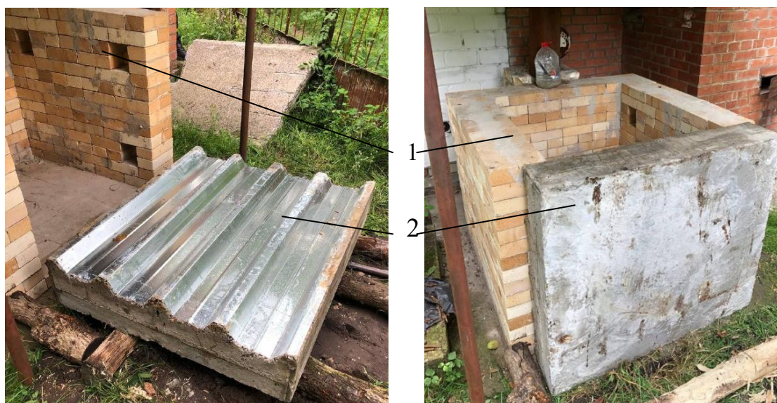
Рис. 2. Фрагмент сталезалізобетонної плити з гофрованим профілем, підготовлений до випробувань: 1 – бокові стінки камери вогневої печі; 2 – фрагмент сталезалізобетонної плити для проведення випробувань
