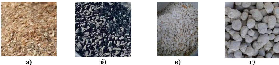
Рис. 2. Фільтруючі насадки: а – деревинна тирса; б – базальт; в – пінополіуретан (ППУ); г – вапняк
