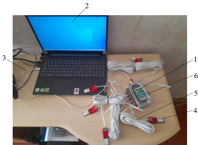
Рис. 1. Вимірювальний комплекс для визначення ефективності технічних засобів пожежогасіння тонкорозпиленою водою: 1 – блок обробки інформації; 2 – ноутбук (повербанк); 3 – кабель USB Type A – USB Type C; 4 – датчики для вимірювання вологості та температури; 5 – комплектний кабель; 6 – карта пам'яті
