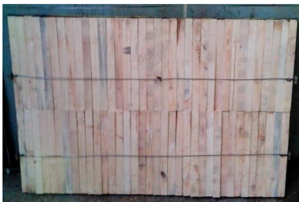
Рис. 1. Імітація підлоги вагону, яка за своїм пожежним навантаженням близька до модельного вогнища 1А
