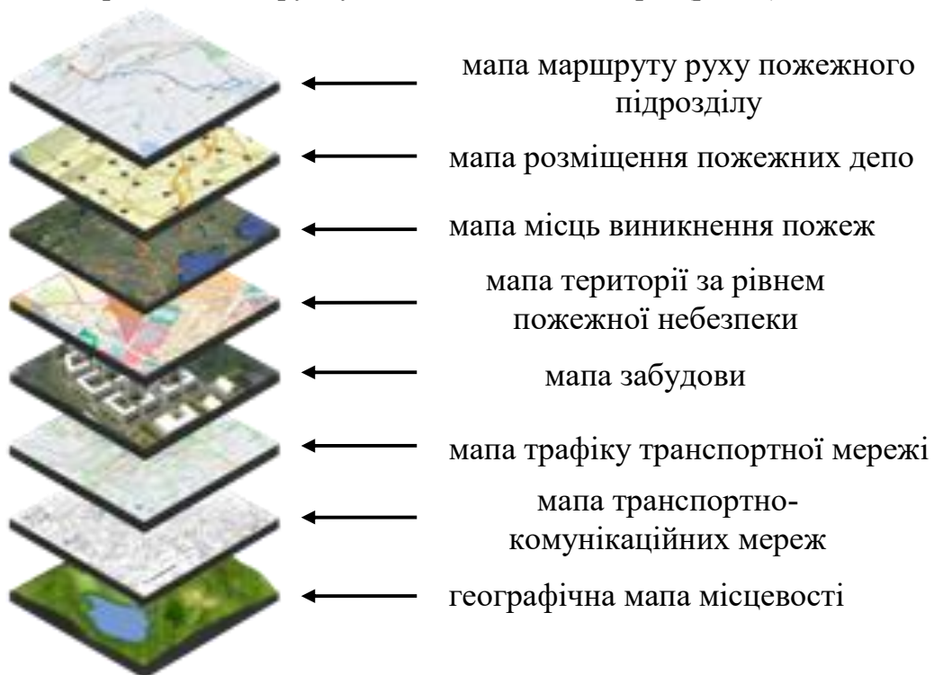
Рис. 2. Структура геоінформаційних систем управління пожежними підрозділами різної функціональної спроможності
