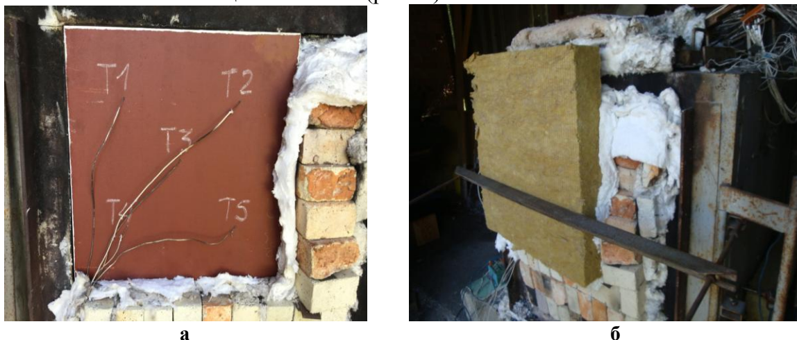
Рис. 2. Схема розміщення термодпар (а) та вигляд зразка з необігрівної поверхні сталеві пластини (б), товщиною 5 мм з мінімальною товщиною вогнезахисного покриття, в точках вимірювання (спучення покриття від 3,2 мм до 4,5 мм)
